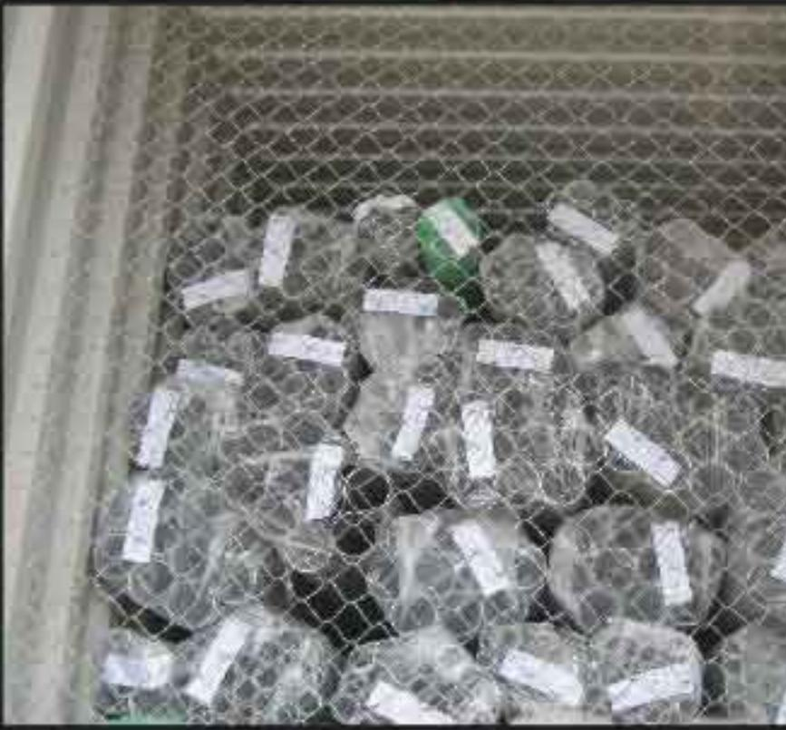
Tất cả ống được bao gói PP theo tiêu chuẩn đóng gói xuất khẩu phù hợp với vận chuyển bằng đường biển và được xếp hàng vào container bằng dây buộc.
