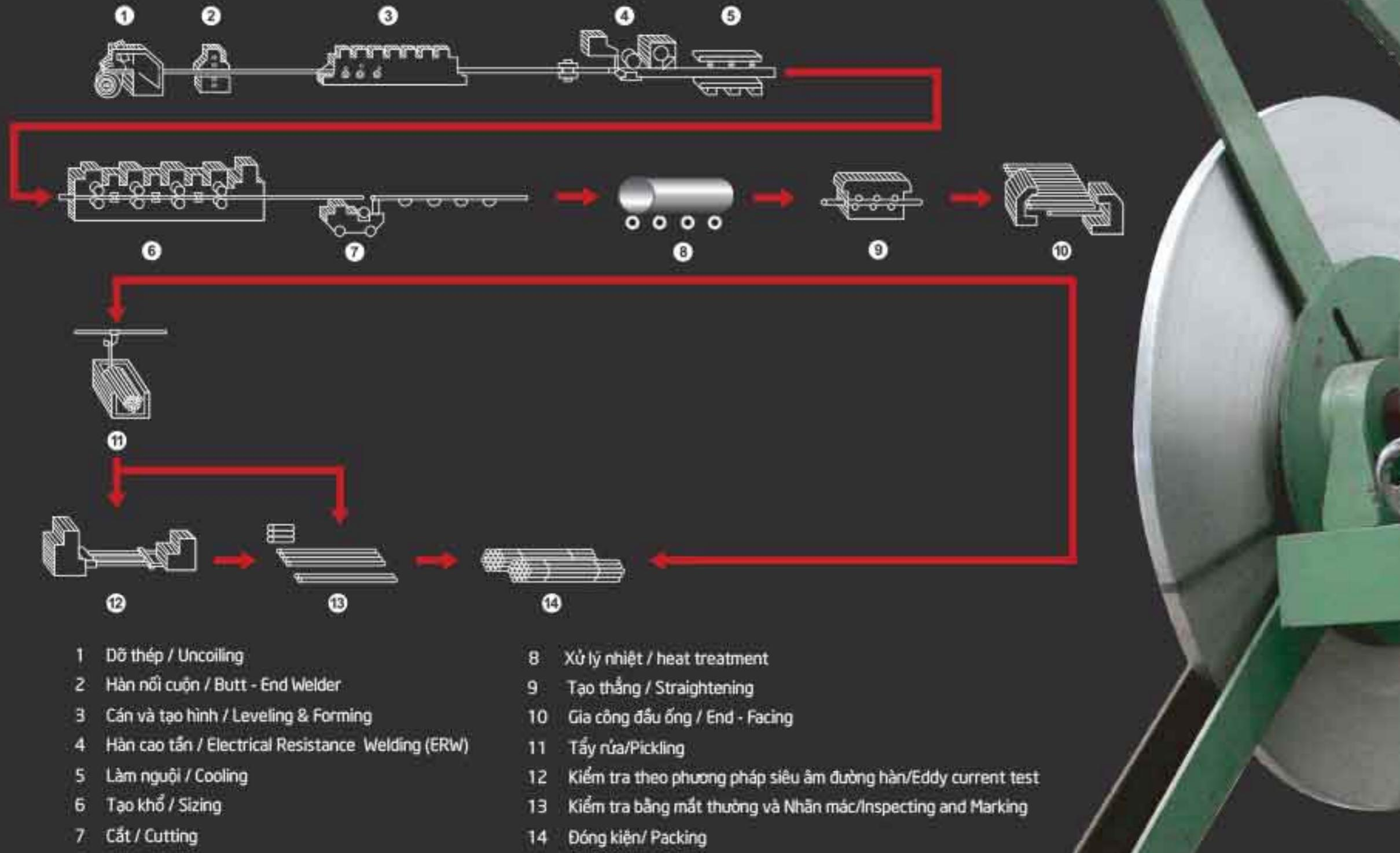
Sản phẩm ống inox của Sơn Hà được sản xuất theo dây chuyền quy mô, hiện đại với nhiều máy móc tiên tiến như máy thử đường hàn, máy thử áp lực, máy đo độ tròn, vuông. Dây truyền này đã được áp dụng trong nhiều nhà máy sản xuất thép không gỉ lớn trên thế giới như Mỹ, Đức. Vì thế tất cả các sản phẩm ống inox của Sơn Hà đều đạt chất lượng theo tiêu chuẩn Mỹ: A312; A778.
